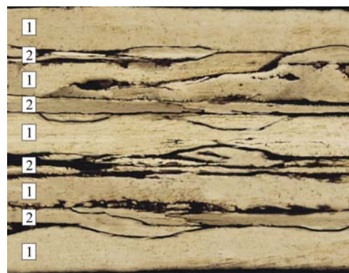
Рис. 5. Микроструктура девятислойного СКМ после ГП с общим высотным обжатием 97–98 %: 1 – слои титана ВТ1-0; 2 – слои стали 08кп (×200)
