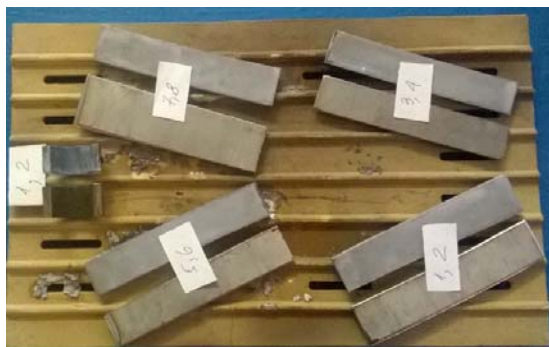
Рис. 1. Схема загрузки образцов-пластин из титанового сплава ВТ1-0 в камерную, муфельную электрическую печь
