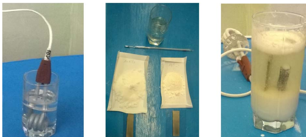
Рис. 3. Технология получения защитного покрытия из нитрита натрия и оксида магния
