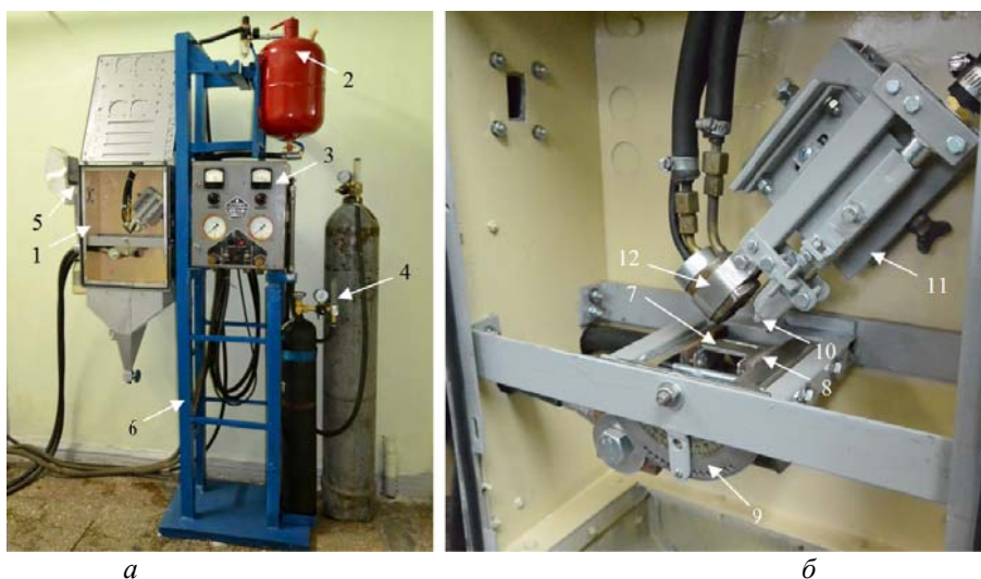
Рис. 1. Общий вид лабораторной установки (а) и испытательной камеры (б): 1 – испытательная камера; 2 – система подачи абразивного материала; 3 – блок управления плазмотроном; 4 – система подачи плазмообразующих газов; 5 – система воздухоочистки; 6 – станина; 7 – образец; 8 – токоподводы; 9 – устройство позиционирования образца; 10 – абразивоструйное сопло; 11 – устройство позиционирования сопла; 12 – плазмотрон. Компрессор, источники постоянного тока для нагрева образца и питания плазмотрона не показаны
