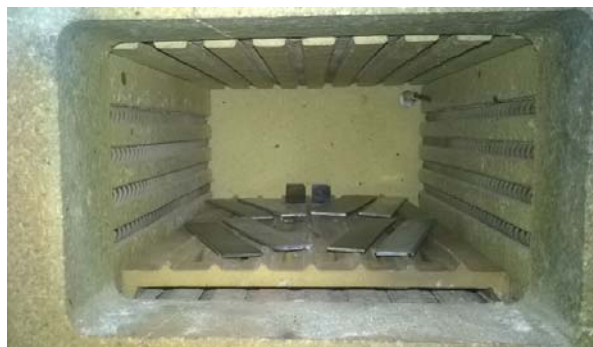
Рис. 1. Схема загрузки образцов-пластин из титанового сплава ВТ1-0 в камерную, муфельную электрическую печь
